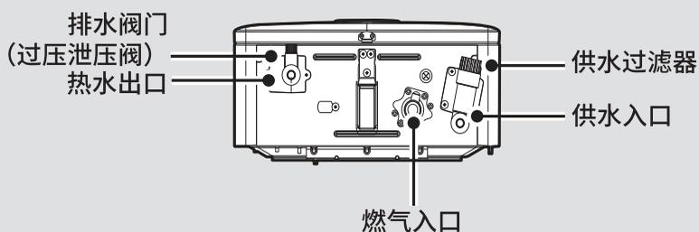
供水过滤器: 过滤供水管内异物的装置。如热水量比平时少或者出现杂音时请清洗过滤器。
